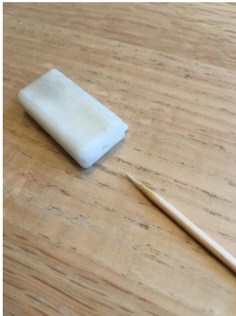
Afbeeldingen: Geboorde gaatje met een saté-prikker dichten en vervolgens glad afsnijden.
