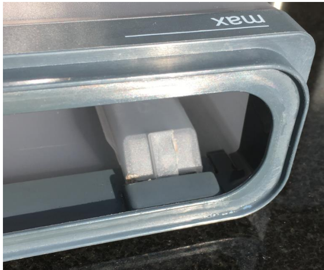
Afbeeldingen: De transparante kolom met de drijvers en de het afgezaagde plaatje dat de kolom borgt.
