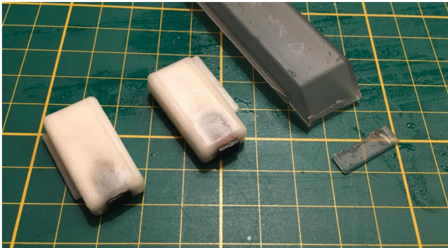
Afbeelding: De witte drijvers met daarin de magneetjes, afgeschermd met een rubberen afdichting.
