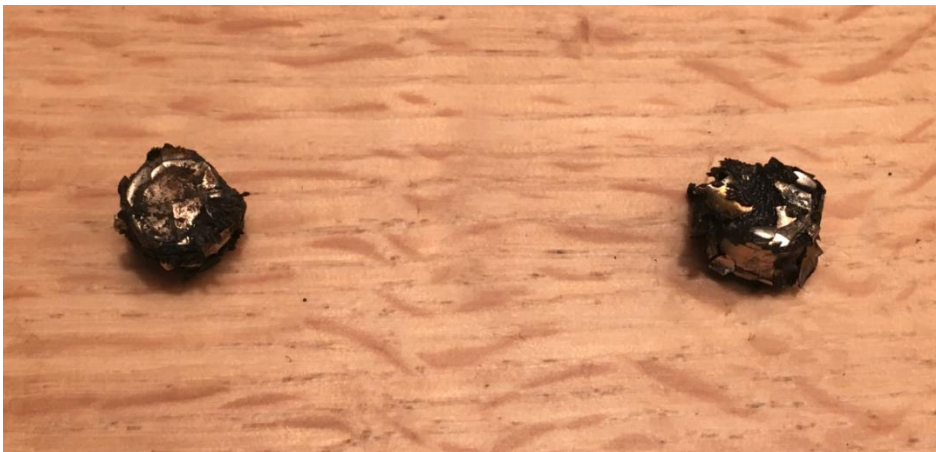
Afbeelding: De twee ernstig verweerde magneten
