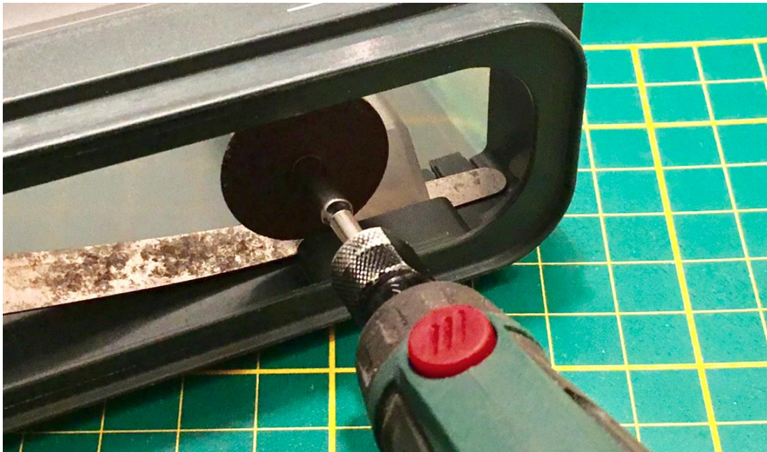
Afbeelding: Doorzagen van de transparantie kolom.
